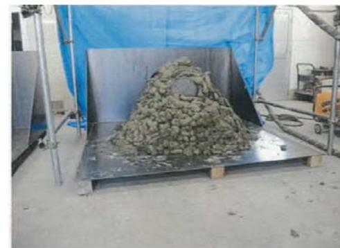
試験結果の例(低スランプモルタル)
