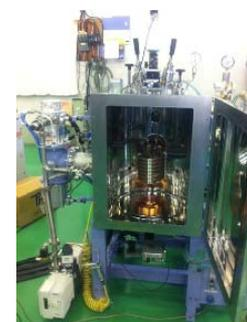
コールド試料( $ZrO_2$ )により性能試験を実施(~2700°C)
