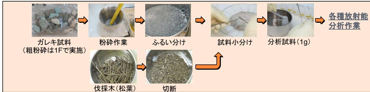
図1 ガレキ、伐採木試料の前処理作業
