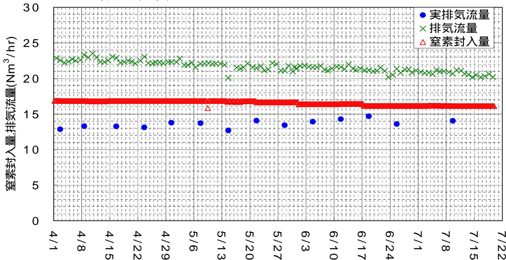
図 3号機 窒素封入量と排気流量の推移
