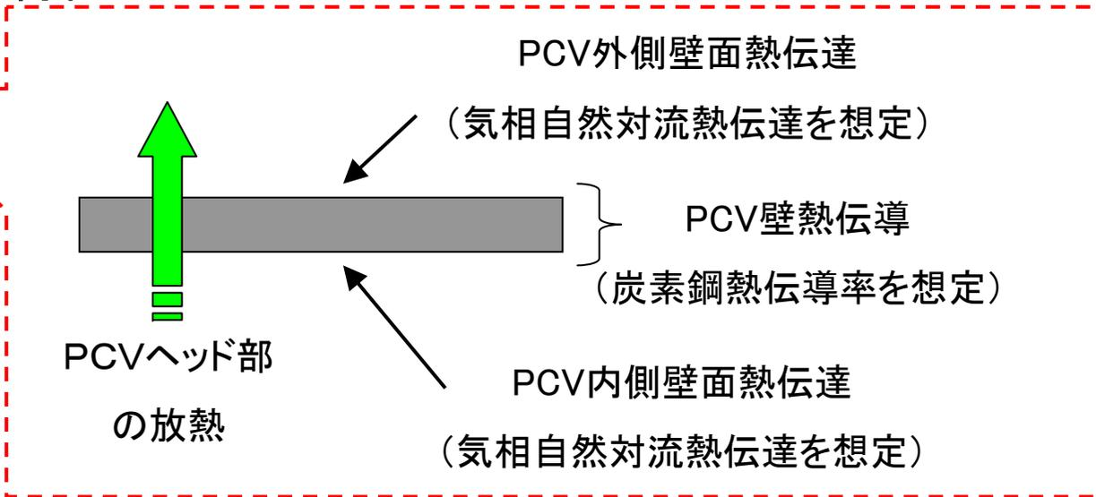
$$D/Wヘッド部の放熱量 : Q = A \times h_p \times (T_1 - T_2)$$
