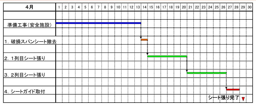
今回のシート張替にあたっては、始めに破損スパンの撤去を実施する必要があり、 作業完了までの間開口となる。
