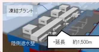
建屋への地下水流入を抑制するため、建屋を囲む陸側遮水壁の設置を計画。2014/6/2から凍結管の設置工事を実施し、2016/2に凍結設備の工事了。2016/3より海側及び山側の一部、2016/6より山側95%の範囲の凍結を開始。2016/12より、山側凍結箇所7箇所のうち2箇所の凍結を開始。2016/10、海側において海水配管トレンチ下の非凍結箇所や地下水位以上などの範囲を除き、凍結必要範囲が全て0℃以下となった。
