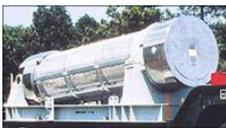
使用済み燃料プールから取り出した燃料を共用プールへ移送するため、輸送容器・収納缶等を設計・製造
