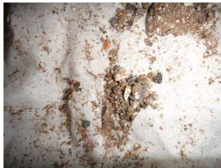
燃料内部から採取した瓦礫、砂礫(瓦礫の表面線量率は1mSv/h程度)
