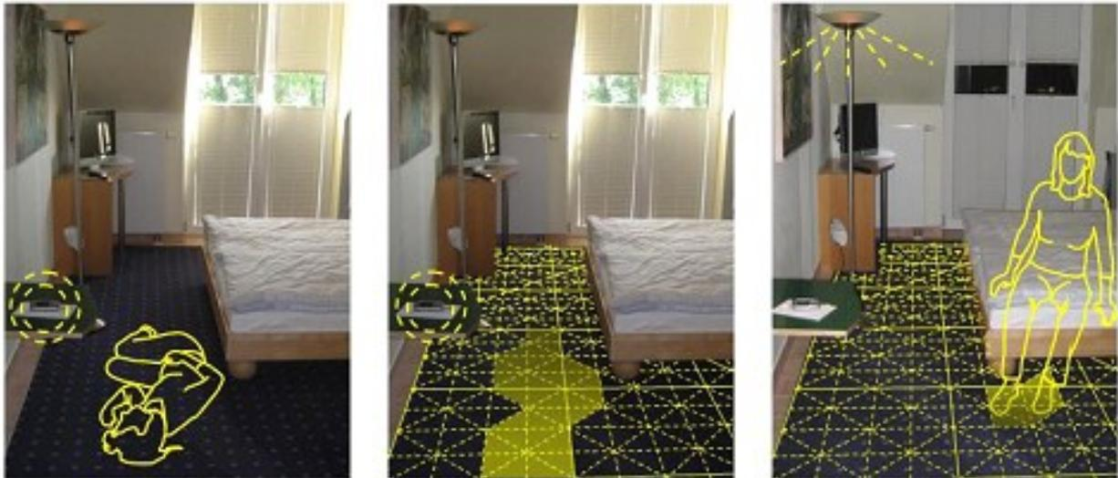
Abbildung 9. Schematische Darstellung des intelligenten Fußbodens, der u.a. Stürze und Bewegungen erkennt.<sup>7</sup>
