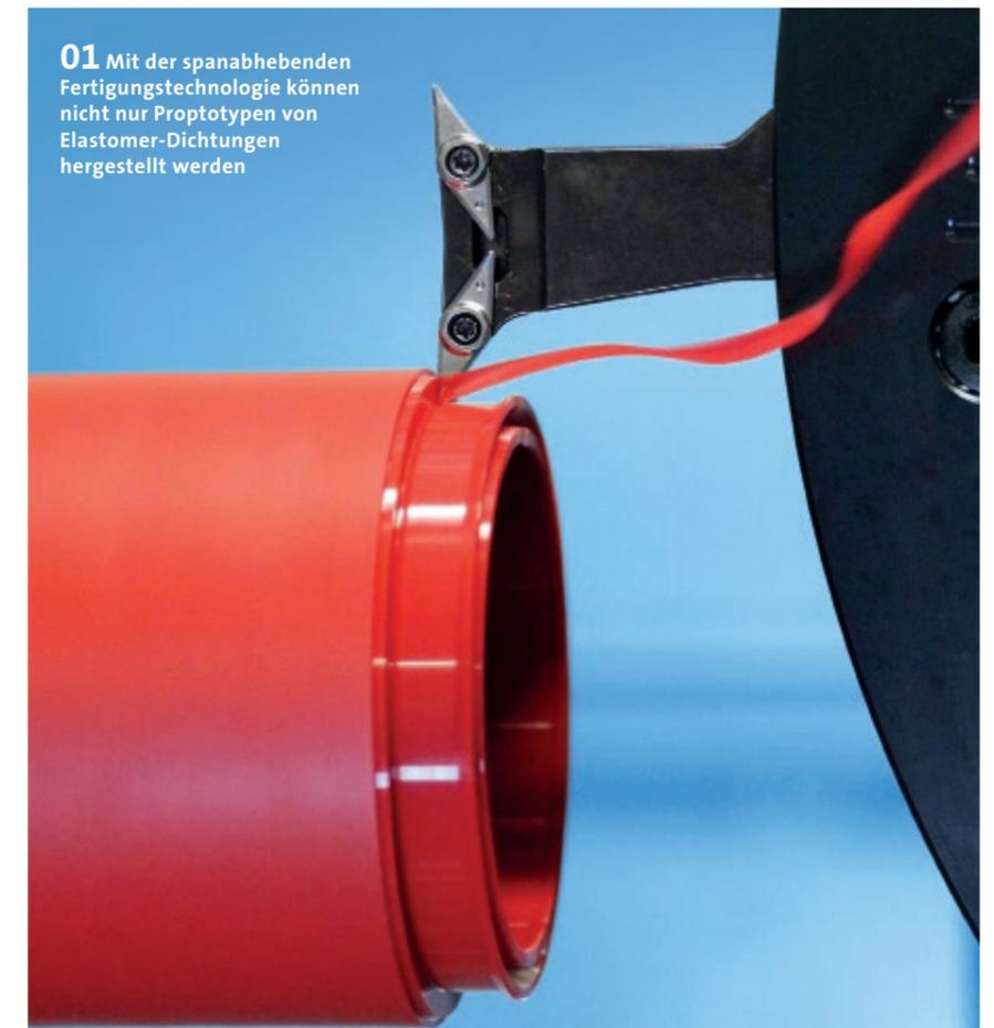
**02** Gedrehte Dichtungen:
